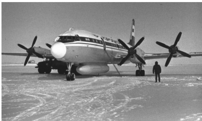
Рис. 2.1.4. Самолет дальней ледовой разведки Ил-24Н, оснащенный радиолокационным комплексом «Нить-С».
