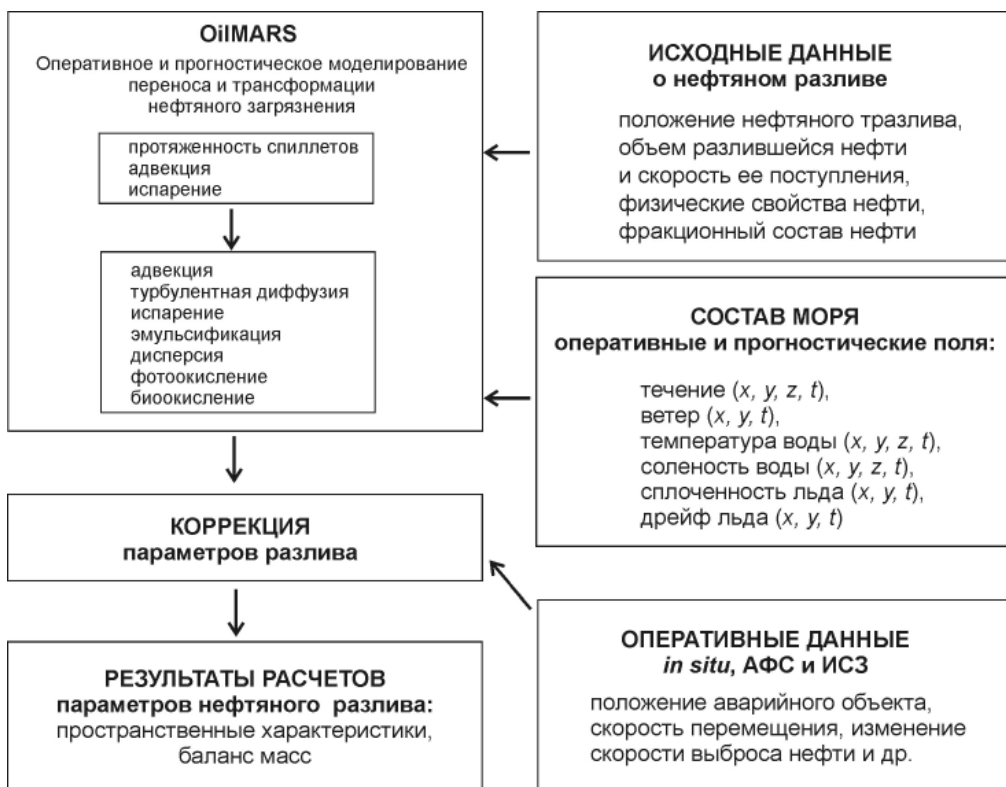
Рис. 4.2.2. Использование модели OilMARS для оценки процесса переноса и трансформации нефтяных загрязнений в арктических морях.
