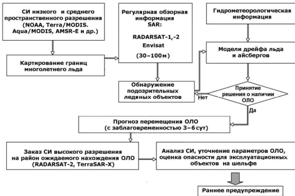
Рис. 4.3.1. Схема использования спутниковых средств дистанционного зондирования для обнаружения и отслеживания ПОЛО.
