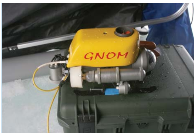
Подводный телевизионный аппарат (ПТА) «Гном»
