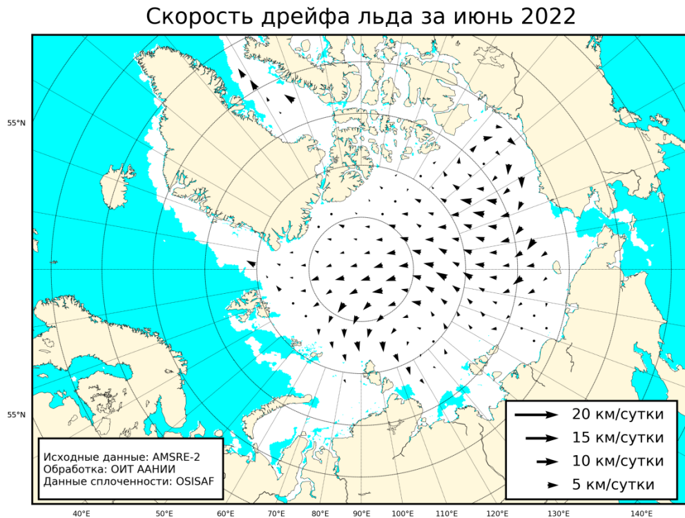
Рис. 2.1.12. Поле скорости фактического дрейфа морского льда в июне 2022 г., восстановленное на основе корреляционного анализа спутниковых изображений льда в микроволновом диапазоне
