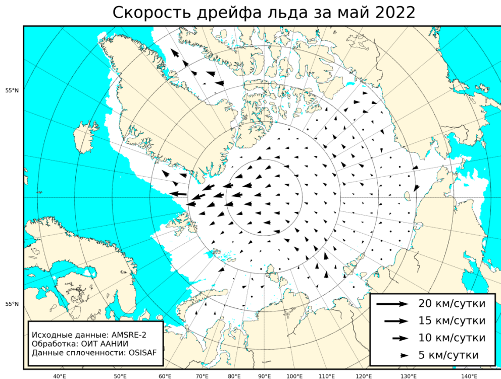
Рис. 2.1.8. Поле скорости фактического дрейфа морского льда в мае 2022 г., восстановленное на основе корреляционного анализа спутниковых изображений льда в микроволновом диапазоне
