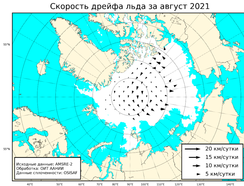
Рис. 2.8. Поле скорости фактического дрейфа морского льда в августе 2021 г., восстановленное на основе корреляционного анализа спутниковых изображений льда в микроволновом диапазоне
