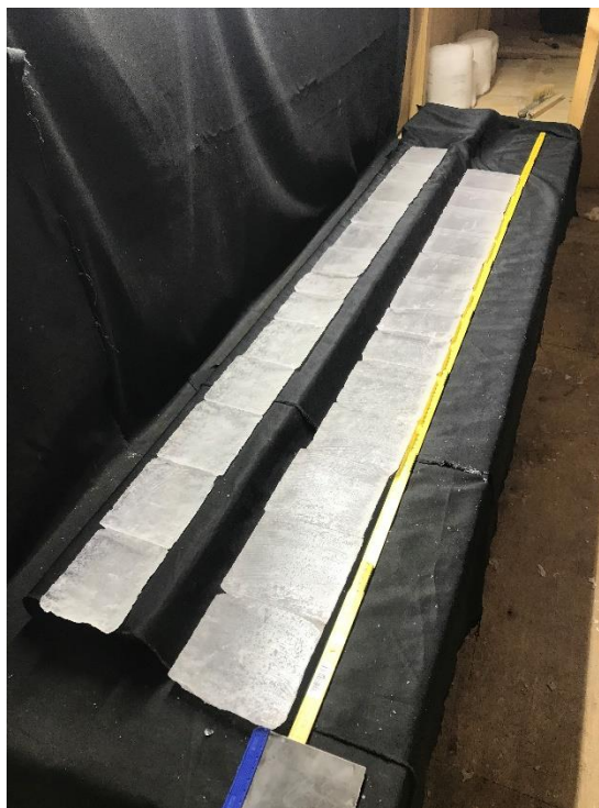
Ледяные керны, полученные при бурении блистера. Фото: Никита Демидов
