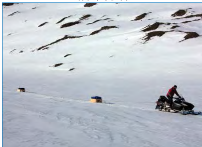
Выполнение радиолокационного зондирования ледника Тунге. Фото А.С.Измайлова.
