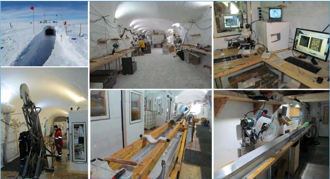
Подземные конструкции EastGRIP. Верхний ряд: вход; научная траншея, где ведется обработка керна; изучение физических и кристаллографических свойств образцов вновь пробуренного ледяного керна. Нижний ряд: буровая вышка в действии; буровая колонна после извлечения керна; первичная обработка ледяного керна.
