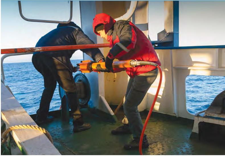
Спуск автономной донной сейсмической станции.
