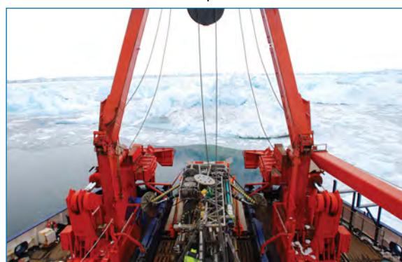
Подводная буровая установка MeBo, залив Пайн-Айленд.
