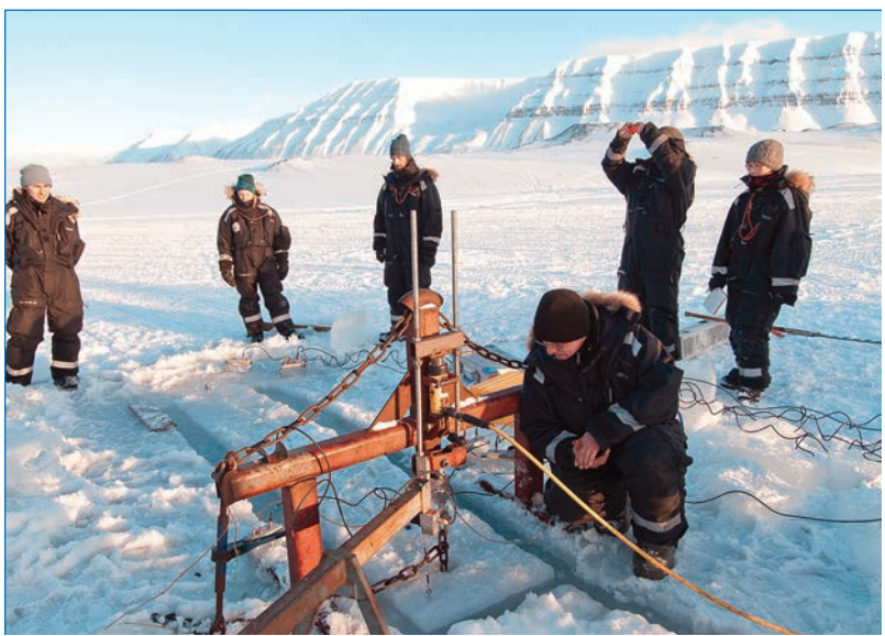
Тест по изгибу консольной балки со смещением вверх конца балки. П.В. Чистяков (МГУ) выполняет контроль эксперимента, на заднем плане студенты курса АТ-211. Ван-Майен-фьорд, март 2016 года. Фото Е. Салганика.
