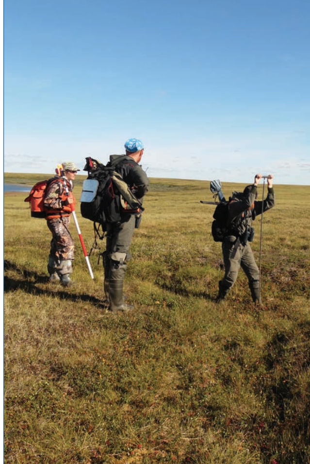
Изучение сезонно-талого слоя с помощью мерзлотного щупа. Полуостров Гыданский, озеро Парисенто. Август 2016 года. Фото А.И. Синицкого.
