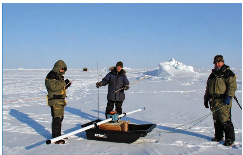
Работа с дистанционным толщиномером EM31-Ice.
