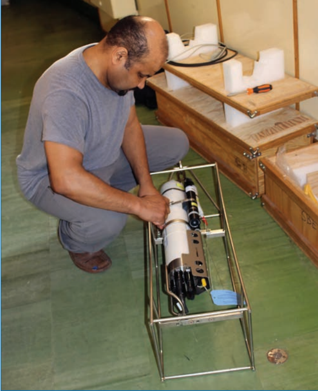
Океанолог А.А. Артамонов готовит к постановке гидрологический зонд.
