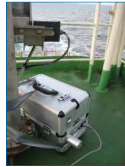
Портативный аэталометр «Портааэталометр-1А» в кейсе с термостатом.
