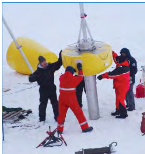
Установка на лед дрейфующих автономных измерительных комплексов.
