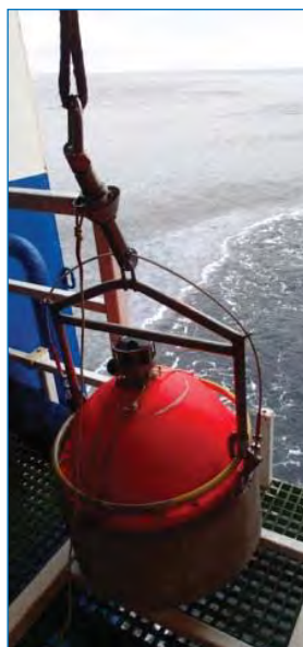
Сброс донной сейсмической станции самовсплывающего типа (слева) и пневмоисточник типа СИН-6М (справа) (разработка ОАО «Севморгео»). Фото Н.Е. Леоновой.
