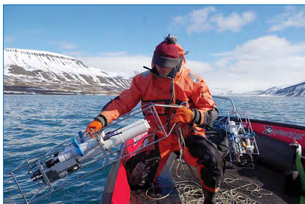
Производство интеркалибровочных измерений приборами SBE 19plus V2 SeaCat, SBE 25plus SeaLogger, RBRconcerto C.T.D\fast 200m, RBRconcerto C.T.D\fast 500m с борта лодки «PolarCirkel» 660 Work
