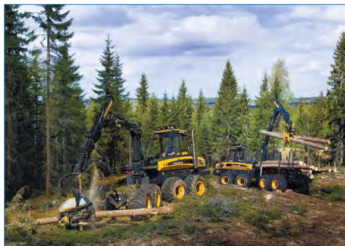
Заготовка леса хвойных пород с помощью современной техники. В работе могучие Харвестеры и Форвардеры.
