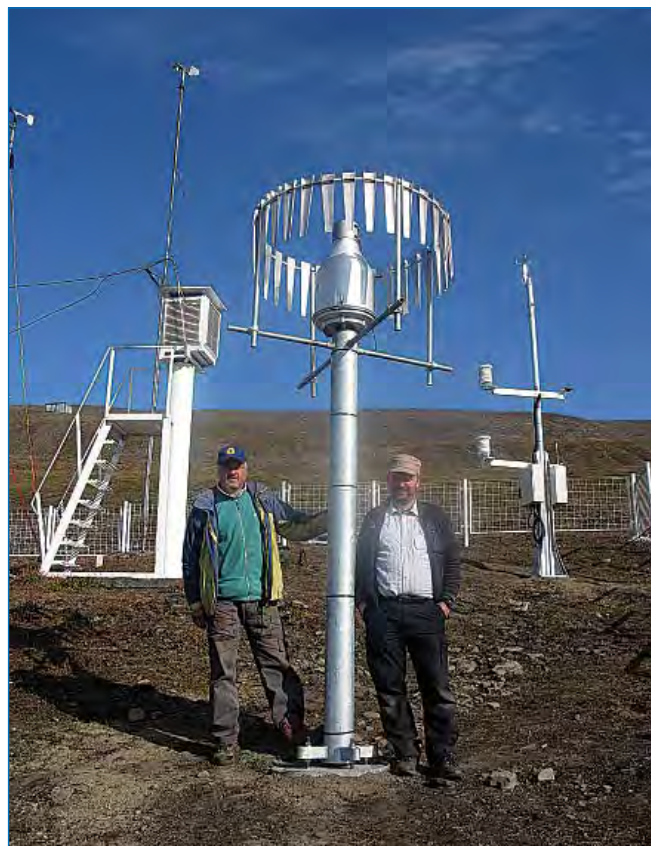
АМС (задний план, справа) на метеоплощадке ГМО «Баренцбург». На переднем плане — участники работ Б. Иванов (ААНИИ) и А. Хамре (НМИ) рядом с установленным осадкомером GEONOR. Фото предоставлено автором.
