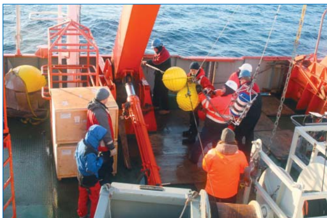
Работы по установке притопленной буйковой станции. Фото предоставлено авторами.
