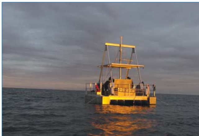
Плавучая платформа UWITEC для отбора колонок донных озерных отложений на Ладожском озере в сентябре 2013 г.
