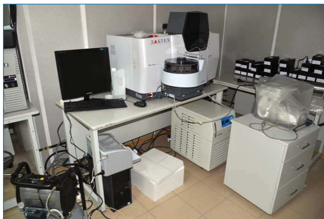
Одно из лабораторных помещений: атомно-адсорбционный спектрометр Shimadzu, AA-7000F.
