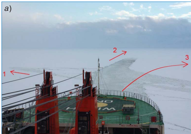
Разворот НЭС «Академик Трёшников» методом «звездочка»: фото полигона (а) и траектория движения судна (б).
