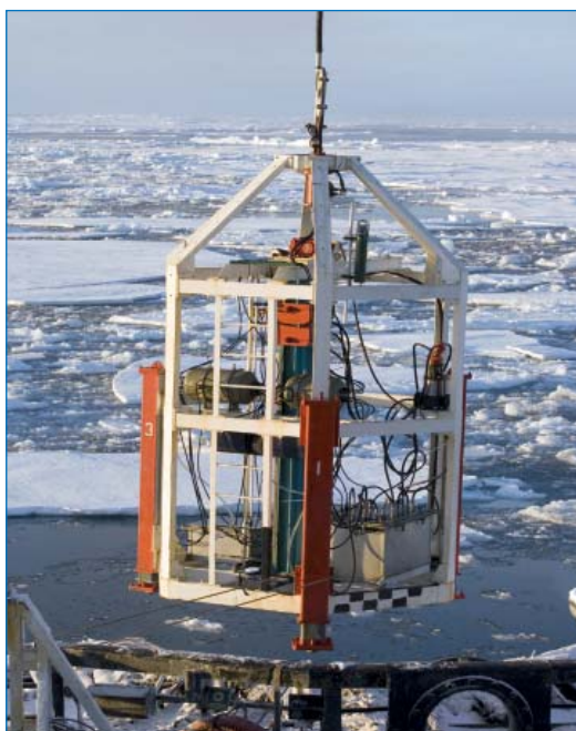
Донный буровой станок ГБУ-2 (ОАО «Севморгео») при выведении его за корму ледокола для опускания на дно (красные штанги – выдвигаемые «ноги» системы горизонтирования).
