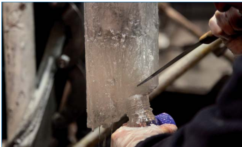
Отбор пробы озерной воды, намерзшей на коронку бурового снаряда. 6 февраля 2012 г., оз. Восток, Антарктида. Фото В.Я.Липенкова.
