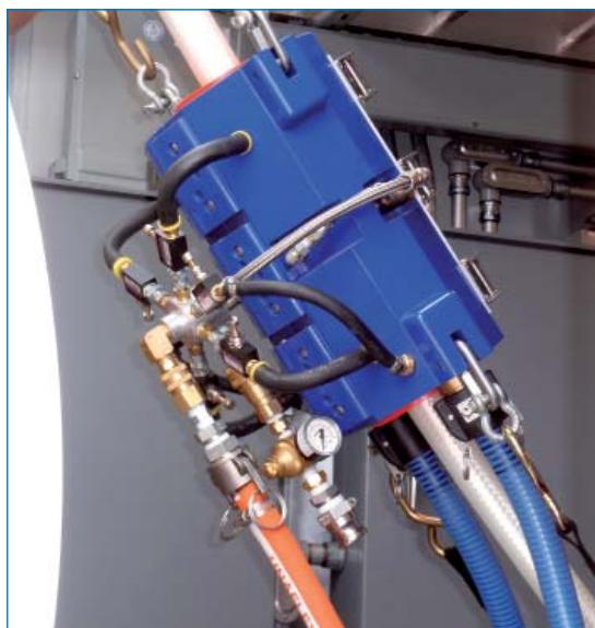
Система очистки шланга перед погружением. Слева – манжета с водой и воздухом, справа – УФ-хомут.
