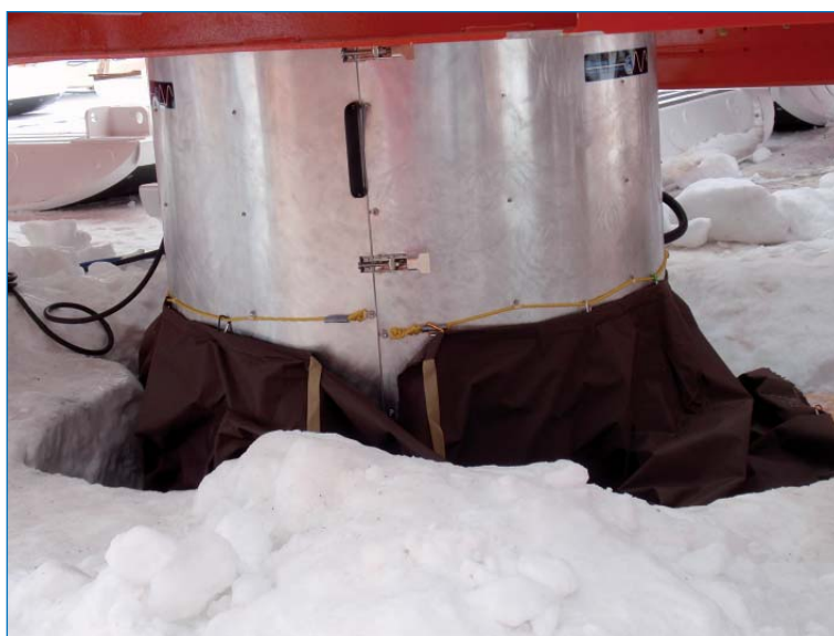
Система очистки шланга перед погружением. Слева – манжета с водой и воздухом, справа – УФ-хомут.
