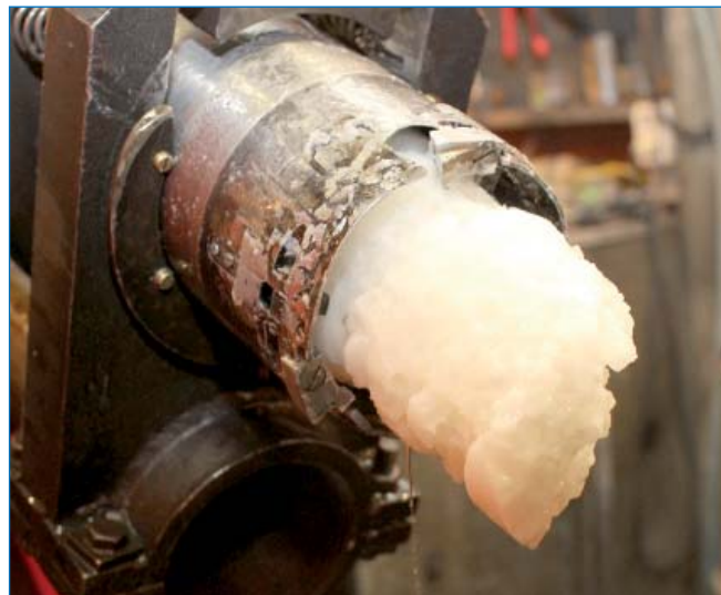
Гидратный керн, поднятый из скважины 5Г-1 с глубины 3419 м.
