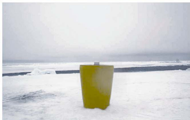
Установка на лед станции нового поколения типа ITP, позволяющей отслеживать физические параметры воды в постоянном режиме. Фото Дж.П.Мейера (J.P. Meyer).
