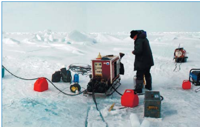
Установка УВБЛ-2 для водяного термобурения.
