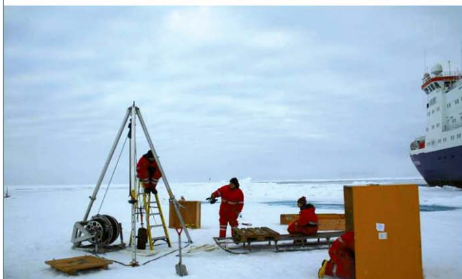
Установка на лед станции нового поколения типа ITP, позволяющей отслеживать физические параметры воды в постоянном режиме. Фото Дж.П.Мейера (J.P. Meyer).
