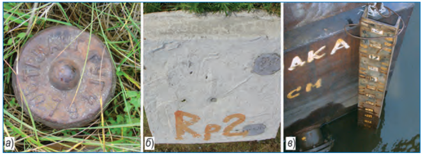
Основной (а), контрольный (б) реперы и уровнемерная рейка (в) станции Сеяха.
