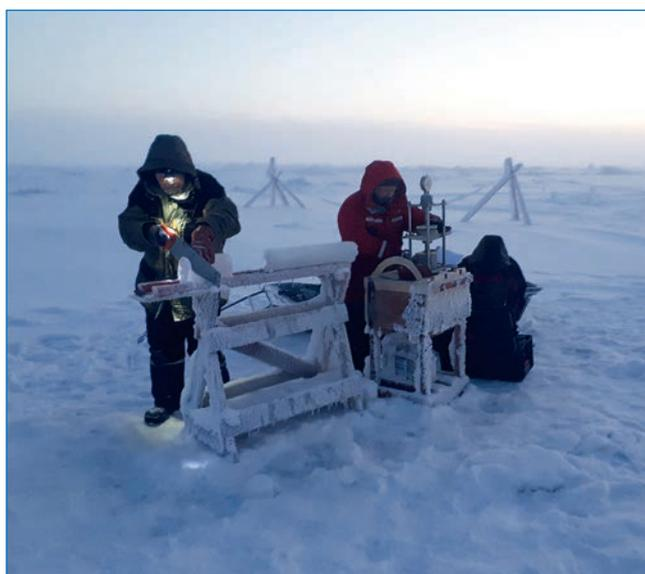
следования механических свойств льда с отбором ледяного блока;
