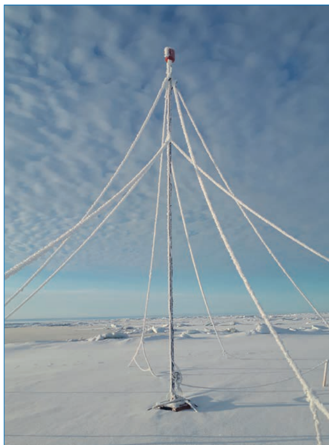
Антенная система для наблюдения за пространственной структурой ОНЧ/СНЧ излучений в приполюсной области Арктики. 18 сентября 2023 года
