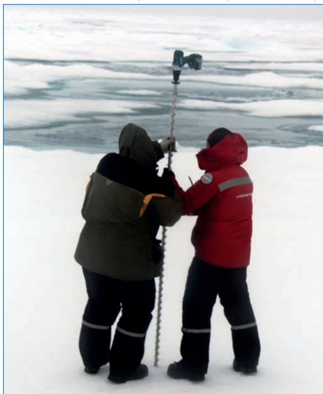
Рис. 4. Промер толщины льда. Фото М.А. Емелиной
