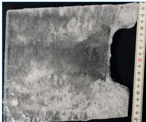
Рис. 8. Текстура зоны разрушения после внедрения индентора на горизонте 30\text{ см} , 21 июля 2023 года
