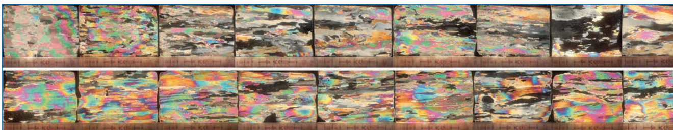
Рис. 6. Структура ровного льда, извлеченного 29 мая 2023 года
