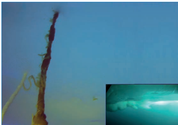
Рис. 18. Состояние нижней части термокосы в киле тороса на полигоне № 3 (первая декада мая 2023 года)
