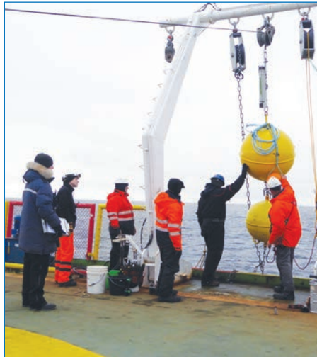
Рис. 1. Постановка долговременной заякоренной ПАБС. Фото из архивов ААНИИ
