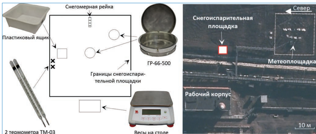
Схема размещения снегоиспарительной площадки и ее наполнения
