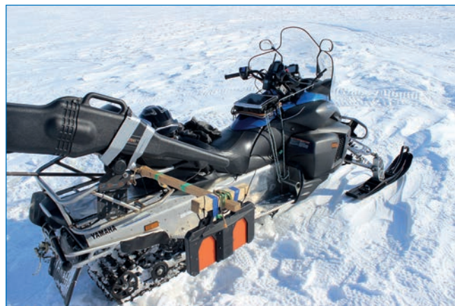
Крепление георадара «Пикор-Лед» на снегоход «Yamaha Venture». Фото И.И. Василевича
