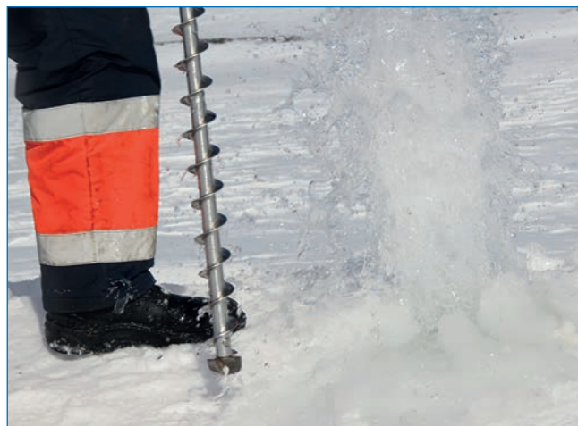
Выход незамерзшего газонасыщенного рассола из ледяного блистера
