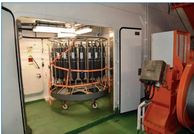
Розетка для отбора проб воды в специальном отсеке на палубе
