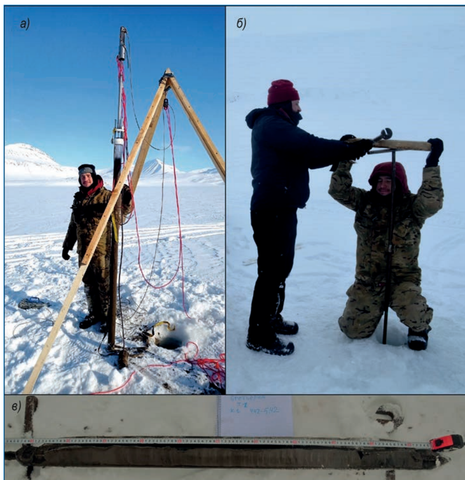
Рис. 4. Процесс отбора гравитационным пробоотборником Uwitec (а), торфяным буром (б), пример колонки донных отложений оз. Бретьорна, представленной глиной, опесчаненной мелкозернистым песком с четкими прослоями (в)
