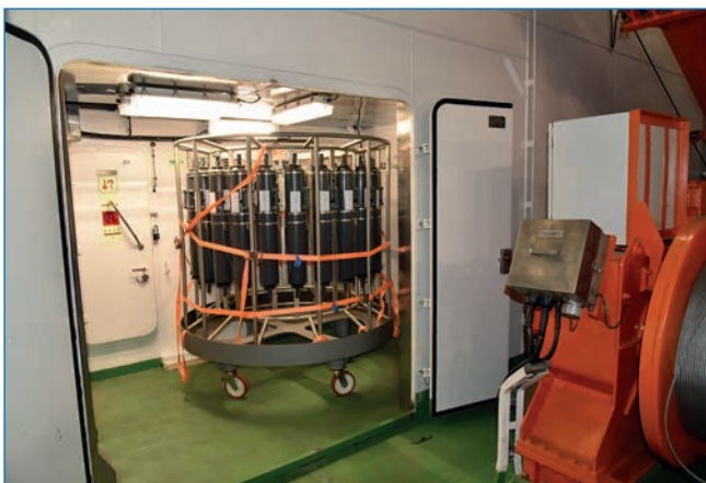
Розетка для отбора проб воды в специальном отсеке на палубе
