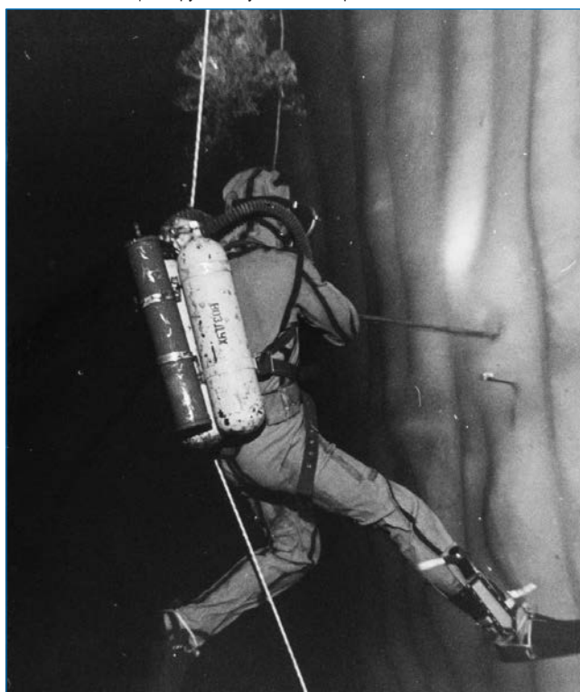
Аквалангист в роли подводного альпиниста добывает колонку льда с частицами грунта. Глубина места работы — 10 м. СП-22
