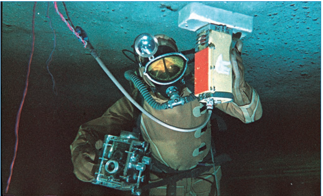
Г.А. Кадачигов устанавливает гидростатические глубиномеры для определения величины стаивания или нарастания подводной части льда. СП-18
