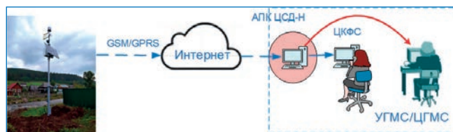
Рис. 1. Типовая схема передачи данных АГК в ЦСДН
