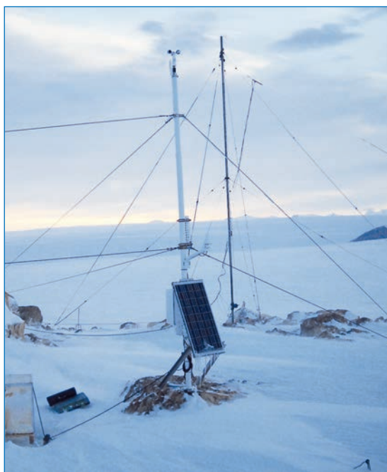
Рис. 2. Автоматическая метеорологическая станция, установленная на полевой базе Ленинградская
