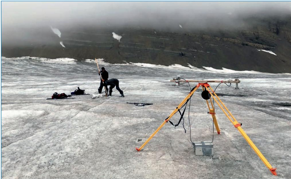
Временная теплобалансовая установка и проверка абляционной рейки в рамках комплексного мониторинга таяния ледника Альдегонда, июль 2021 г.
