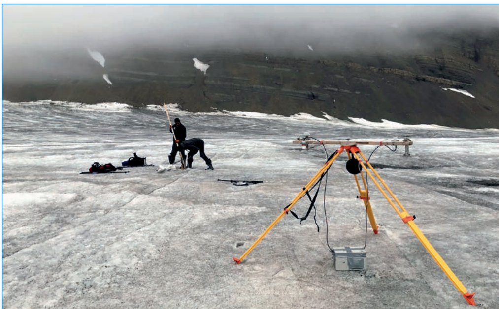
Временная теплобалансовая установка и проверка абляционной рейки в рамках комплексного мониторинга таяния ледника Альдегонда, июль 2021 г. Фото У.В. Прохоровой
