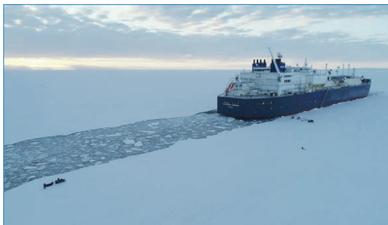
Промеры толщины льда вдоль канала за газовозом «Владимир Воронин»
