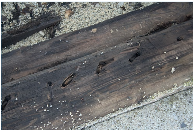
Рис. 6. Доски обшивки бортов. Видны «вицы» и следы обработки топором
