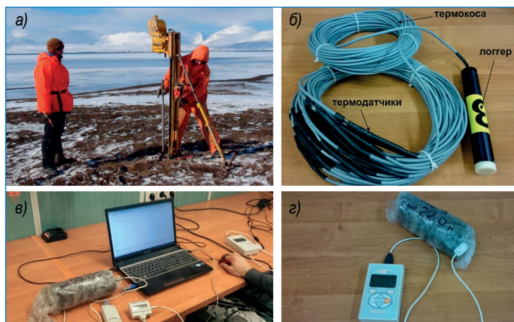
Рис. 3. Примеры оборудования для использования в ходе создания пунктов мониторинга ММГ (а – буровая установка УКБ-12/25; б – термокосы «МГУ-геофизика»; в – прибор KD2-PRO для определения теплопроводности грунтов; г – термометр цифровой для определения температуры кернов и температуры начала замерзания)
