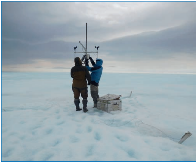
Установка автоматической метеостанции на леднике Мушкетова. Фото Д.Ю. Большианова
