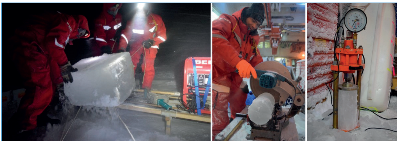
Измерение прочности льда на одноосное сжатие
