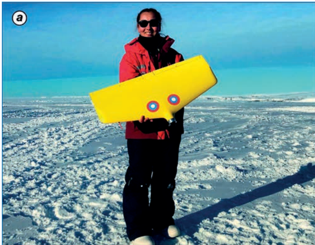
а – общий вид БПЛА ZALA 421-08M; б – общий вид наземной станции управления (НСУ) на базе тягача Kässbohrer PistenBully Polar 300; в – запуск БПЛА при помощи эластичной катапульты; г – парашютная посадка БПЛА
