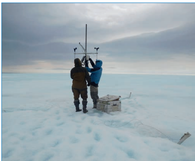
Установка автоматической метеостанции на леднике Мушкетова. Фото Д.Ю. Большиянова
