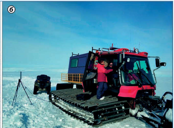
а – общий вид БПЛА ZALA 421-08M; б – общий вид наземной станции управления (НСУ) на базе тягача Kässbohrer PistenBully Polar 300; в – запуск БПЛА при помощи эластичной катапульты; г – парашютная посадка БПЛА
