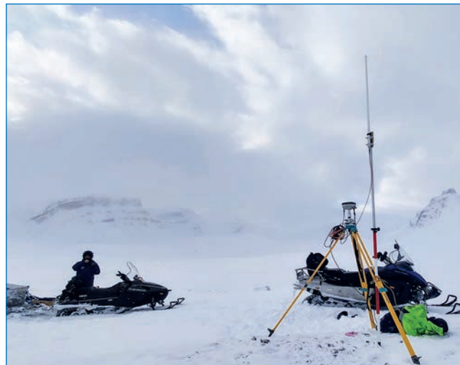
Установка базовой станции SOKKIA на морене ледника Альдегонда. Фото А.Л. Борисик
