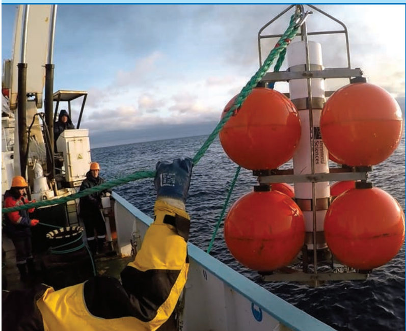
Установка донной станции в Карском море
