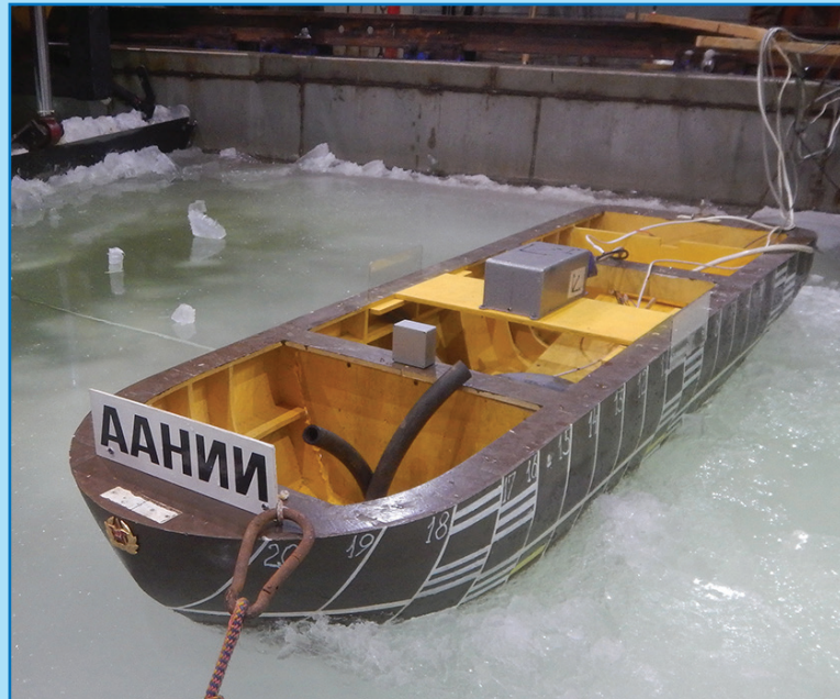
Общий вид ледового бассейна ААНИИ и испытания модели ЛСП при сжатиях во льдах
