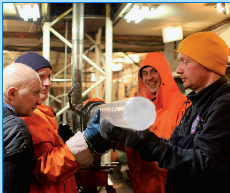
Станция Восток, январь 2013 года. Извлечение ледяного керна длиной более 2 м
