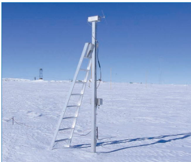
Датчик (вращающийся диполь) для измерения атмосферного электрического поля на станции Восток. Фото автора
