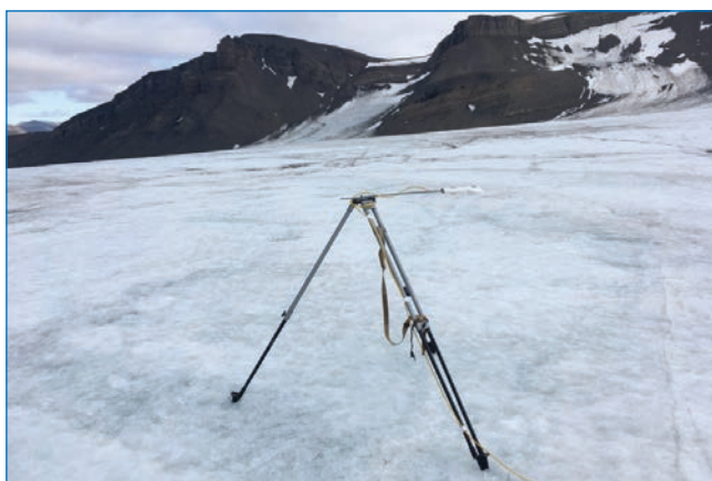
Радиометр CNR-4 на леднике Альдегонда
