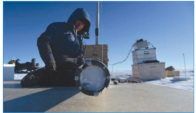
Рис. 4. Скважина VK19. Буровой снаряд с вновь добытым керном поднят на поверхность. Фото А.Н. Верес
