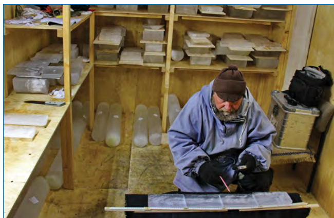
Рис. 5. Изучение текстуры льда в «холодной» ледовой лаборатории
