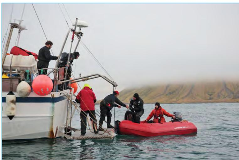
спусками осуществлял водолаз-спасатель международного класса, водолазный врач С.А. Ковалев. В подводных работах приняли участие еще четыре водолаза-исследователя. Основная часть работ производилась с борта MS «Alter Ego». В обеспечении спусков также применялись две моторных лодки. Водолазные работы производились с использованием легководолазного снаряжения открытой системы.
