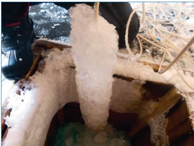
Обрастание фала пластинками внутриводного льда
