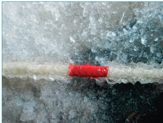
Фал, обмотанный ПВХ-лентой
