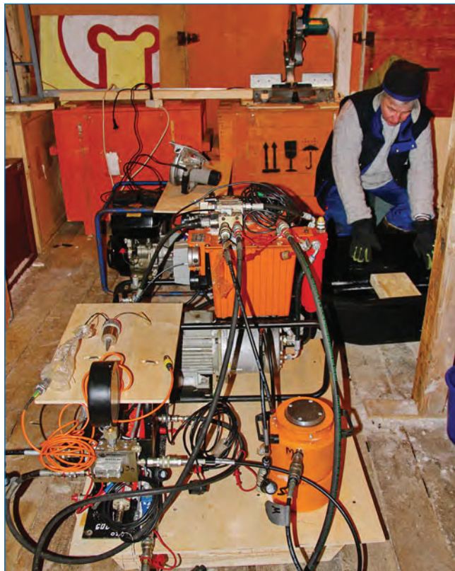
Рис. 6. Монтирование комплекса зонд-индентора на сани в центральном зале ледового павильона
