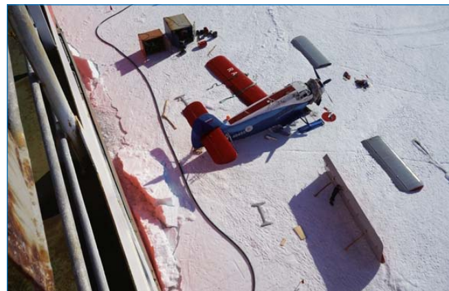
Сборка самолета Ан-2 на припайном льду у борта НЭС «Академик Федоров». Фото Д.М. Воробьева
