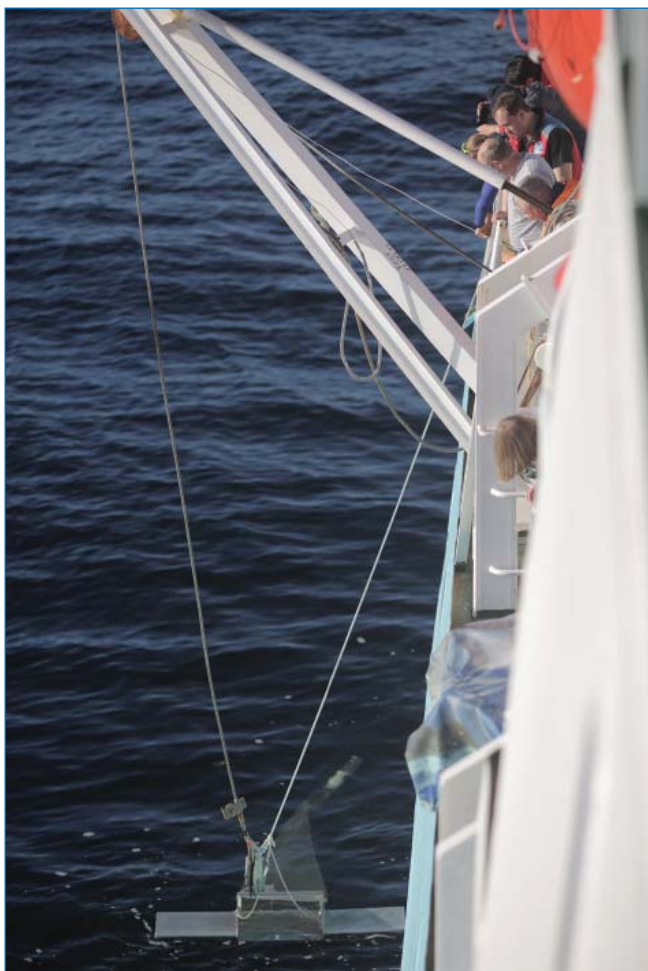
Отбор проб воды на содержание микропластика сетью «Манта». Фото С.С. Пряжина
