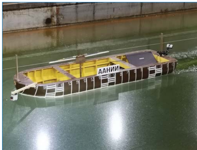
Модельные испытания ледопроницаемости ЛСП в сплошном ровном льду. Фото Н.А. Крупиной
