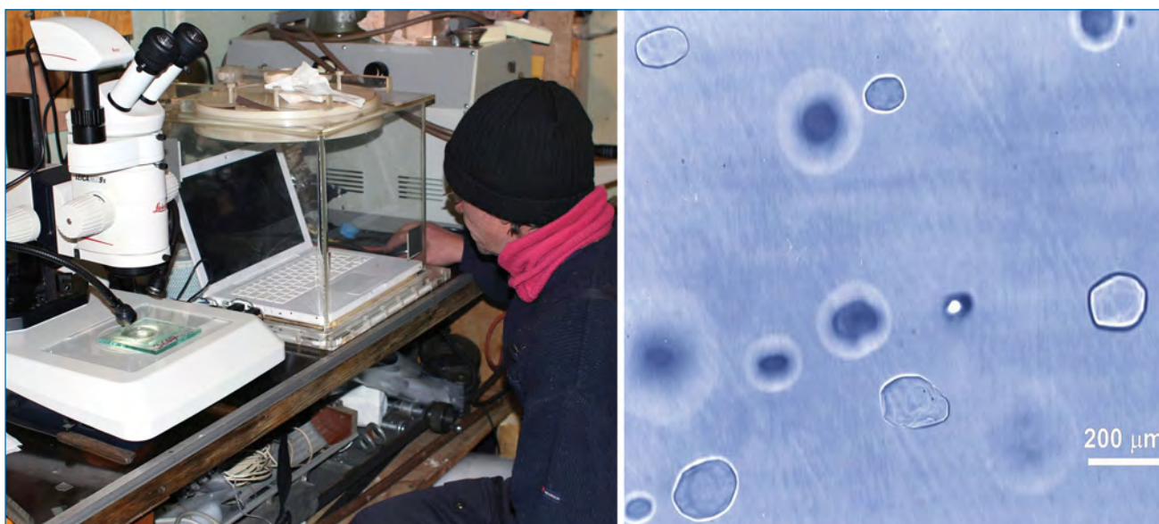
Микроскопические исследования кристаллических включений гидратов воздуха в шлифах древнего льда в холодной гляциологической лаборатории станции Восток
