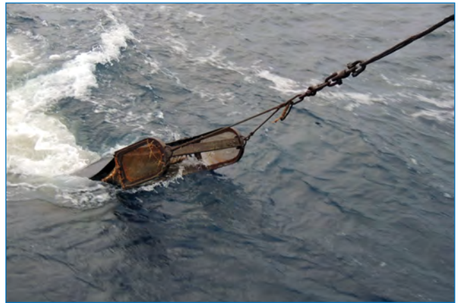
Подъем трала Сигсби на борт НИС «Дальние Зеленцы» в Баренцевом море. Фото М.А. Павловой
