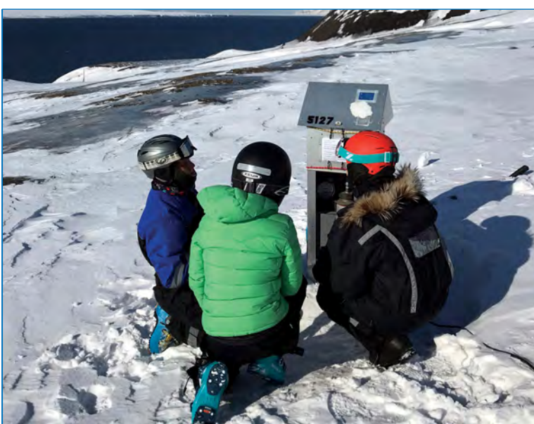
Установка насоса для отбора воздуха
