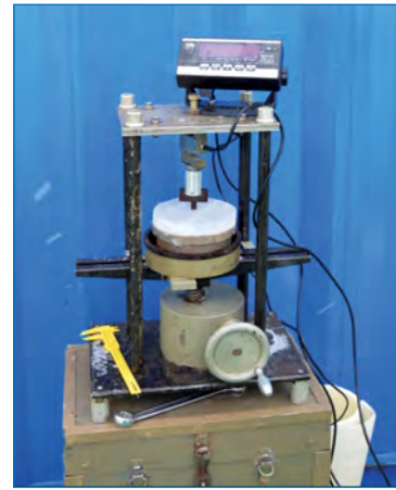
Испытания изгибной прочности льда на малых образцах
