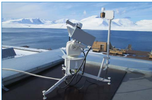
Внешний вид солнечного фотометра SP-9, установленного на крыше ГМО «Баренцбург»
