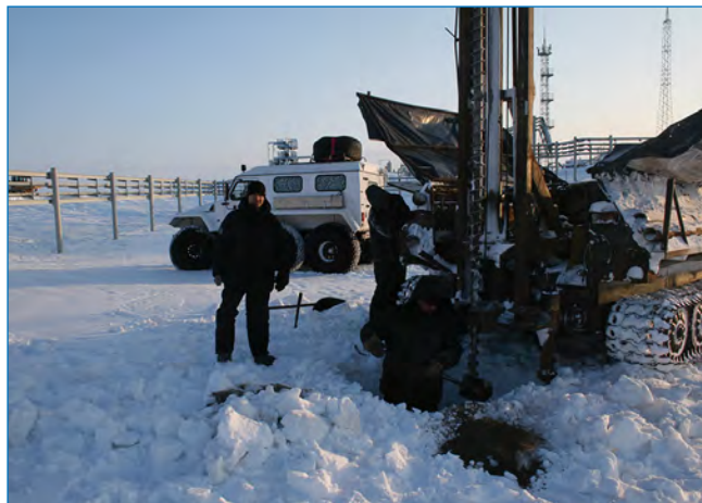
Установка сейсмодатчика на полуострове Ямал.
