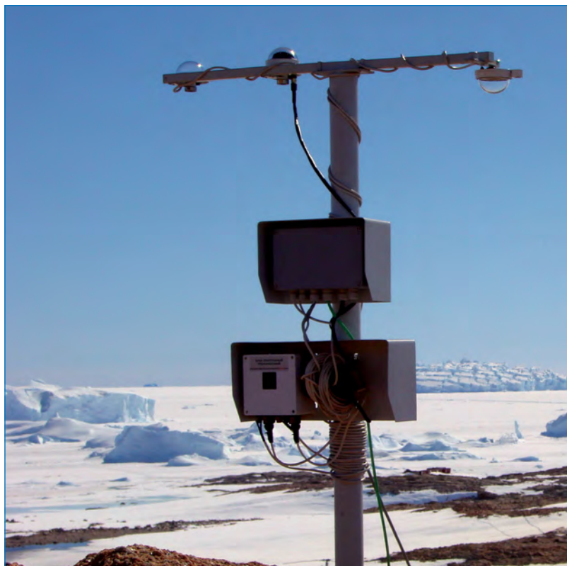
Некоторые научные приборы БАЭ: Лидар Р (слева), автоматическая метеостанция АСАН (справа)
