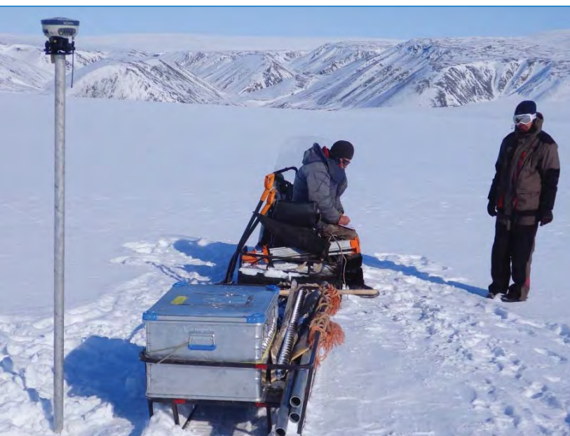
Планово-высотная привязка ледомерно-скоростной вехи на леднике Семенова-Тян-Шанского
